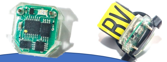
GLS-logger, våt/tørr- sensor
